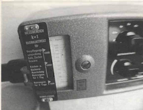
Foto 10 - Particolare dello strumento con una scala aggiuntiva montata. Queste scale indicano dei limiti massimi di contaminazione accettabili dai soldati per vari materiali (cibo, vestiti, materiale strategico).
