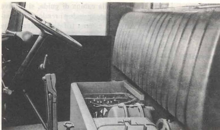
Foto 3 - Motore elettrico di alimentazione a corrente trifase (scoperto sotto il sedile).
