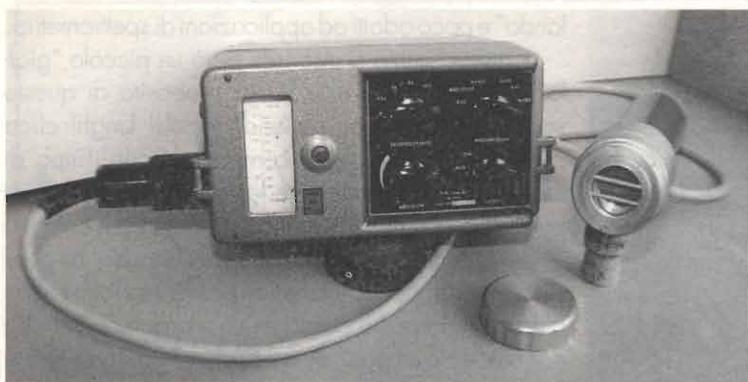
Foto 5 - Primo piano dello strumento collegato alla sonda per raggi  $\beta$  e  $\gamma$ . La finestra sensibile ai  $\beta$  è aperta e si intravedono le due sbarrette di protezione del cristallo.
