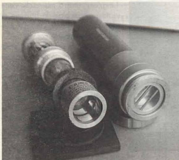
Foto 8 - Un'altra vista interna della sonda per raggi  $\beta$  e  $\gamma$ : è visibile la sostanza plastica scintillatrice all'interno del corto tubo di alluminio che la protegge da colpi e vibrazioni.
